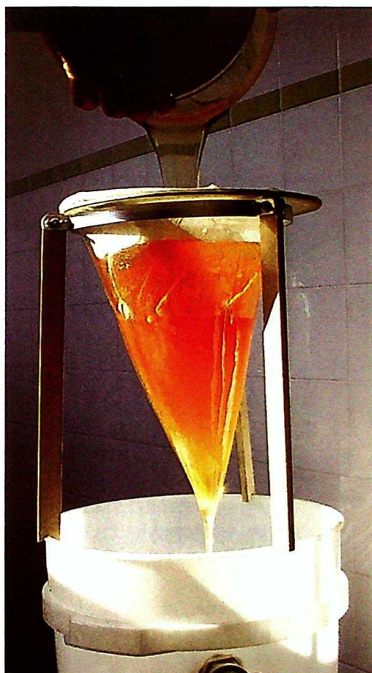
Två silar varav den ena med masktäthet 0,2 mm ger honungen den renhet konsumenten är van vid.
